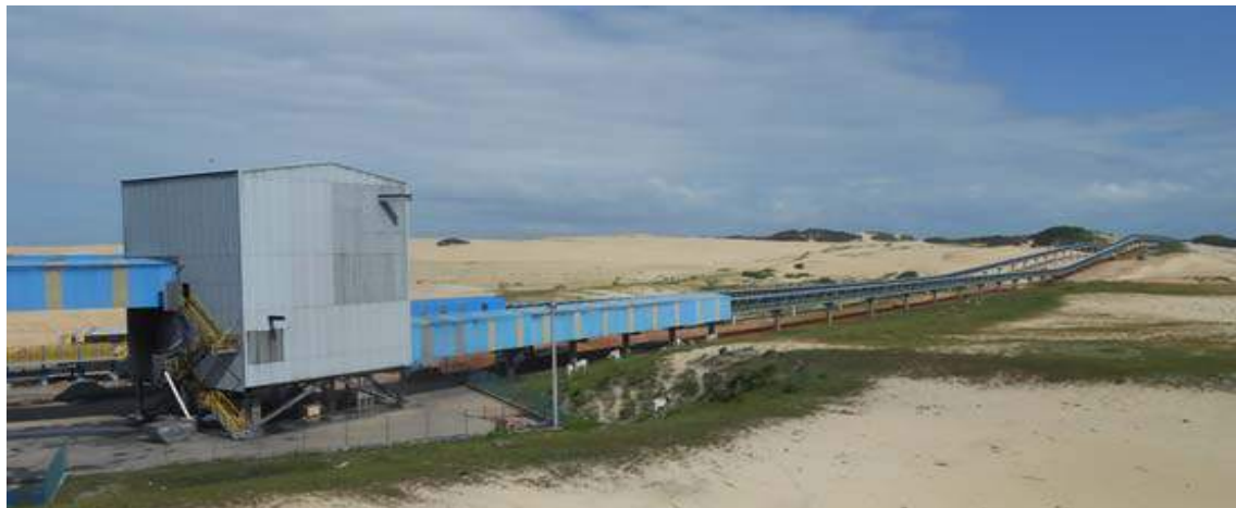
Foto 7.150: Esteiras transportadoras de carvão mineral, que abastecem empresas do CIPP. Fonte: Engesoft, 2016.
